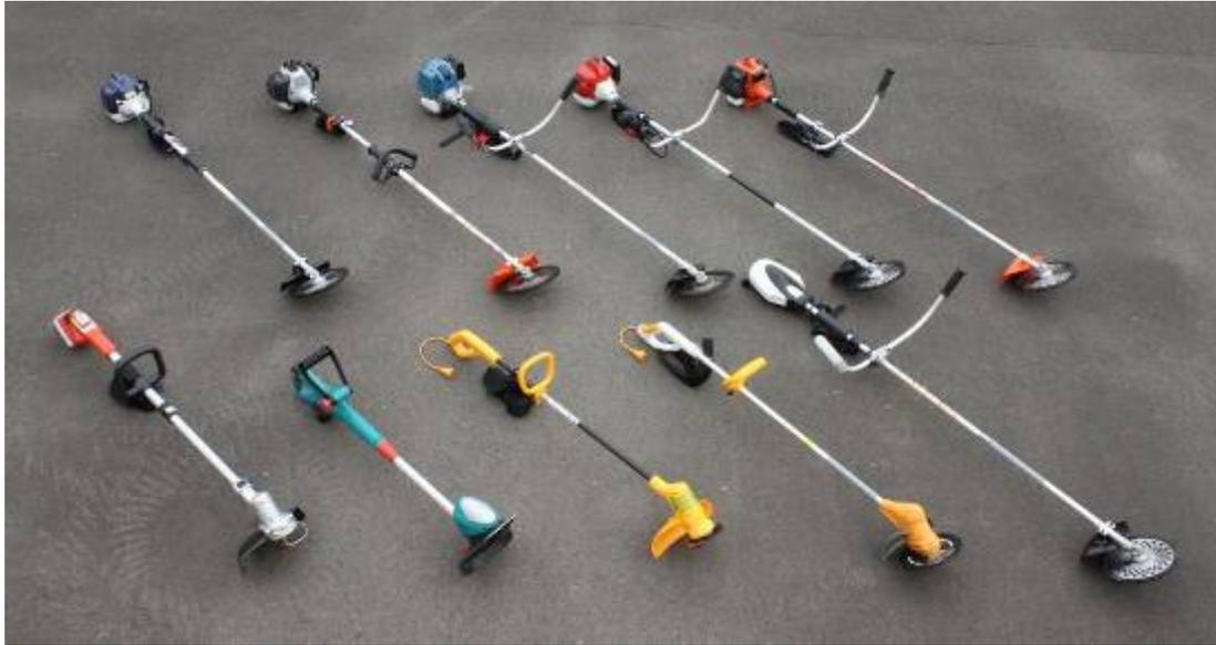
上段がエンジン式刈払機、下段が電動式刈払機
