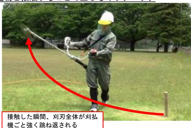
写真6. 刈刃の右側部分が地面と接触することで生じるキックバック
