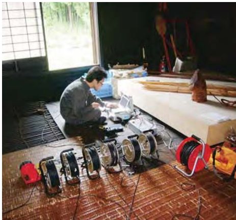
常時微動計測調査状況
